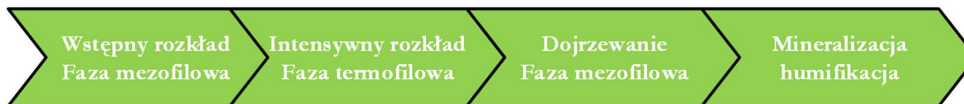
Rys. 15. Schemat poglądowy procesu kompostowania bioodpadów [opracowanie własne]
